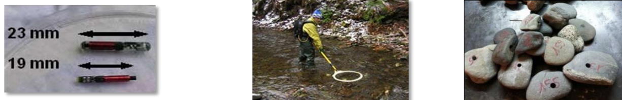
Figure 11 : (a) Pit-tag de 23 et 19 mm, petite antenne de recherche (b) et (c) galets percés avant insertion d'un PIT-tag.
